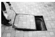
⑤EHキーでふたを手前に引くとふたのつばが ローラーにのりスムーズにふたが開きます。
